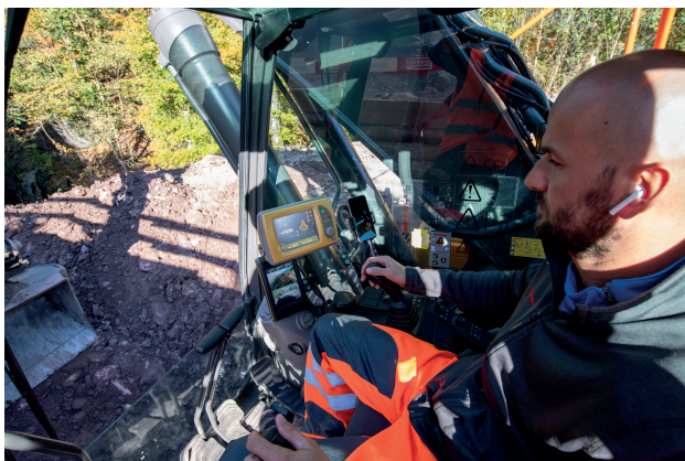
Abbildung 87: KW Schils: 3D-Baggersteuerung
